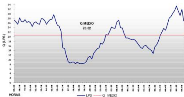
Medición continua de caudal antes de la prueba (sin cierre de conexiones domiciliarias) Q_{\text{medio}} = 20.62 \text{ L/S}
